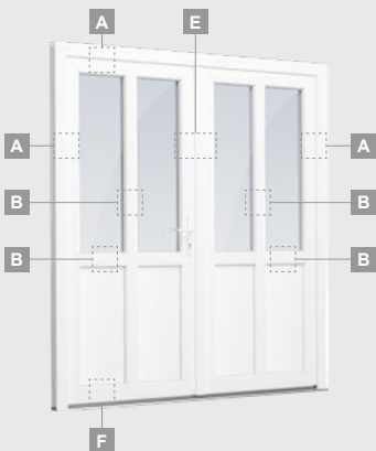
Dvivėrės lauko durys su 2 horizontaliais ir 4 vertikaliais skersiniais, su 4 stiklo ir 4 PVC užpildais
